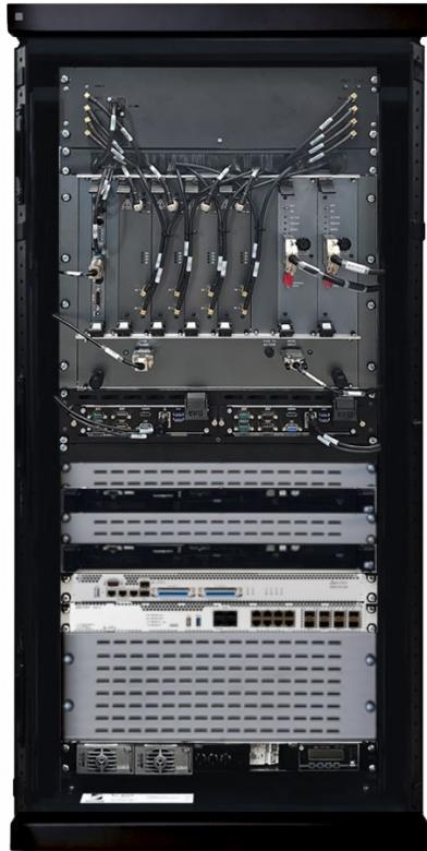
**Узловая базовая станция** представляет собой элемент сети, обеспечивающий связь между абонентскими радиостанциями, находящимися в зоне обслуживания и оборудованием сети TETRA. Сервисные возможности станции позволяют организовать индивидуальную или групповую связь между пользователями в дуплексном и полудуплексном режимах, обмен статусными и короткими сообщениями, а также передачу данных с различными скоростями в зависимости от применяемого кода помехозащиты и количества используемых каналов.
